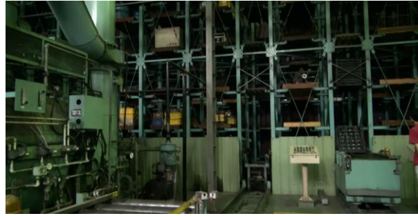
圖 9 廠內滲碳自動化熱處理設備 系統運作
